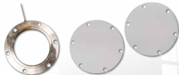
En substance, le système est constitué de deux membranes séparées par un disque intermédiaire creux ou une série de cales spéciales. Les deux membranes sont fortement comprimées l'une contre l'autre et ne sont séparées qu'au niveau de leur bordure extérieure. Comme il n'y a aucun fluide et très peu d'air entre les deux membranes, la zone intermédiaire ne subit aucune pression du processus, sauf en cas de défaut de l'une des membranes. Si une membrane
